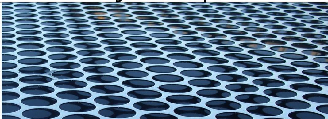
I vagli a fori sono prodotti in lamiera, realizzati secondo le misure costruttive delle varie macchine e dotati di divisori. Vengono zincati a prodotto finito. Il forato piano è il vaglio consigliato per l'inferiore. Il passo estremamente fitto dei fori garantisce la massima resa di produttività e pulizia senza precludere la resistenza meccanica della lamiera.
